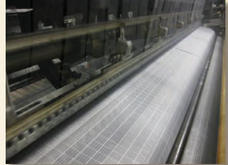
*La tecnología de trama se utiliza para reforzar muchas de las telas de ABC para minería, túneles e industrias de construcción subterráneas.*
