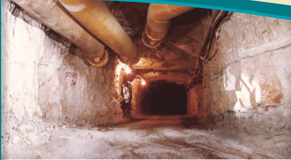
Enlazado molecularmente para aplicaciones de presión positiva, MineVent® está fabricado con el material VentaTex® de ABC. MineVent® está diseñado para un rendimiento a temperaturas de -20 °F a 180 °F (-29 °C a 82 °C) continuamente en ambientes subterráneos. Las telas MineVent® están probadas y aprobadas por los estándares de la Administración de Seguridad y Salud en la Minería (MSHA).
